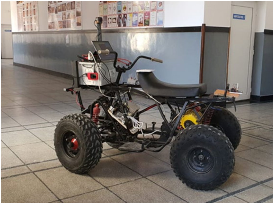
Fig. 2 Prototip al unui vehicul electric autonom de la Universitatea din Petroșani (Rus et al., 2021)
